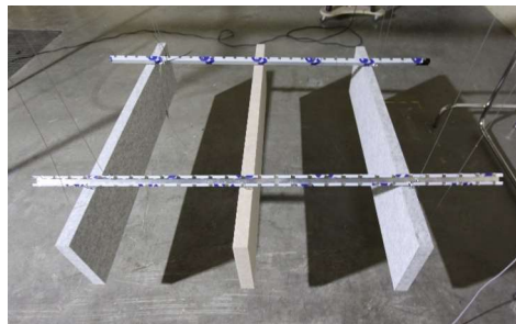
Photo : Test 13 : 1 élément de grille avec 3 SlimBox Baffles
