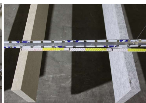
Photo l'essai 13 : un objet = 1 grille avec 3 Slimbox Baffles suspendus à des rails en U avec un espacement de 500 mm entre les centres (points de suspension) des baffles
