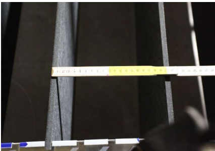
photo : la distance de 200 mm entre les rangs de SlimUp panel
