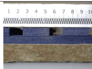
photo : section transversale d'un panneau SlimWall Line sur le panneau de laine de roche
