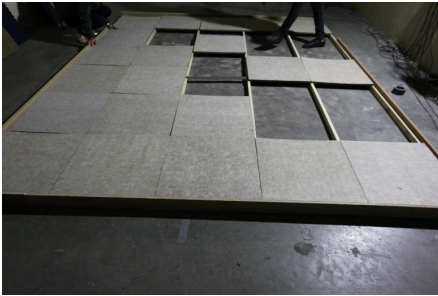
photo : essai n° 17 : Les panneaux de laine de roche, d'une épaisseur de 20 mm sur un cadre en bois d'une hauteur de 45 mm.
