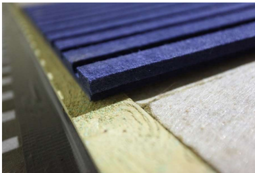
photo : essai n° 22 : Les panneaux SlimWall Lines sur un cadre en bois d'une hauteur de 22 mm remplis avec 20 mm laine de roche
