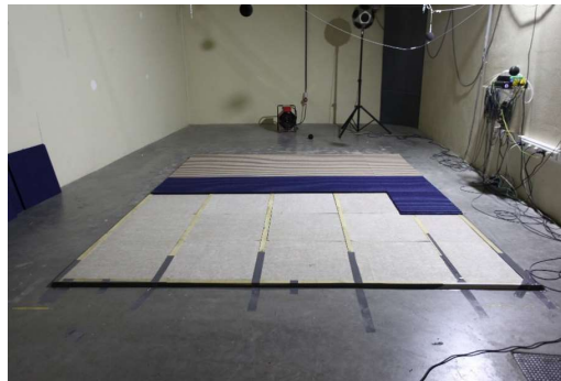
photo : essai n° 22: lors l'installation des panneaux sur le cadre rempli avec la laine de roche
