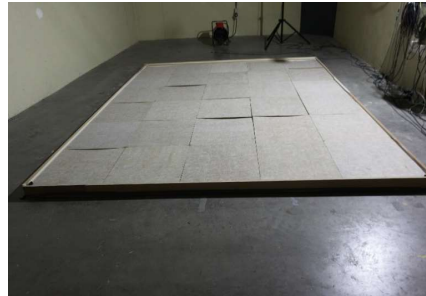
photo : essai n° 17 : Les panneaux de laine de roche, d'une épaisseur de 20 mm sur un cadre en bois d'une hauteur de 45 mm.
