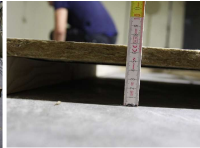
photo : essai n° 17 : Les panneaux de laine de roche, d'une épaisseur de 20 mm sur un cadre en bois d'une hauteur de 45 mm.
