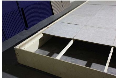
photo : essai n° 21 : Les panneaux de laine de roche, d'une épaisseur de 20 mm sur un cadre en bois d'une hauteur de 270 mm.
