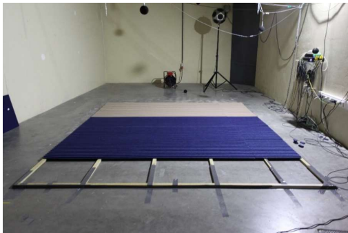
photo : essai n° 23: lors l'installation des panneaux sur le cadre vide
