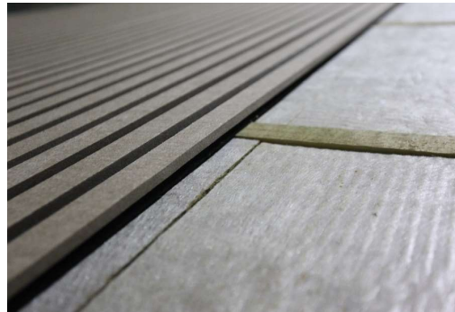
photo : essai n° 22 : Les panneaux SlimWall Lines sur un cadre en bois d'une hauteur de 22 mm remplis avec 20 mm laine de roche
