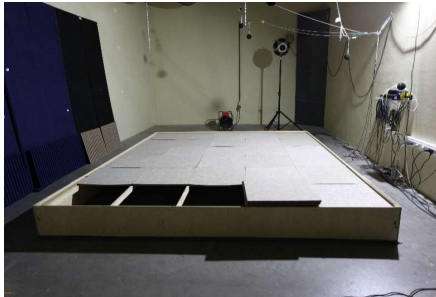
photo : essai n° 21 : Les panneaux de laine de roche, d'une épaisseur de 20 mm sur un cadre en bois d'une hauteur de 270 mm.
